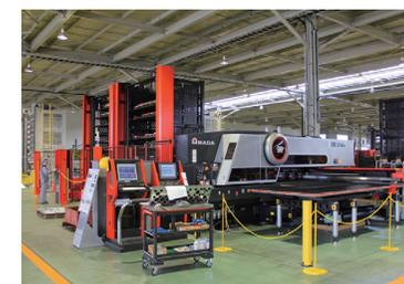
コンピュータ管理のもと、ステンレスコイルを最適なサイズに自動裁断する「FMSセンター」の製造ライン。長尺ものの製作においても溶接が不要になるなど、作業の効率化・迅速化に大きく寄与している。
