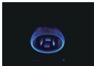
●φ 90 一重バーナ強火 (B) 5.2kW (4,500kcal/h)
