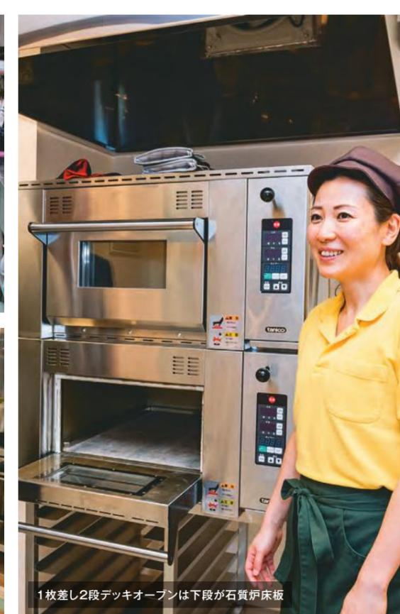
1枚差し2段デッキオーブンは下段が石質炉床板
