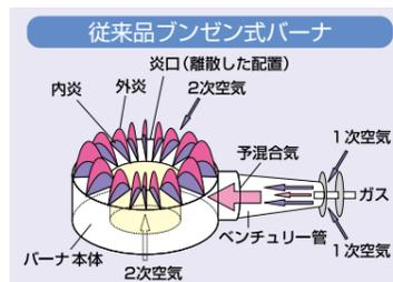
炎口がバーナ表面に離散的に設置されている
