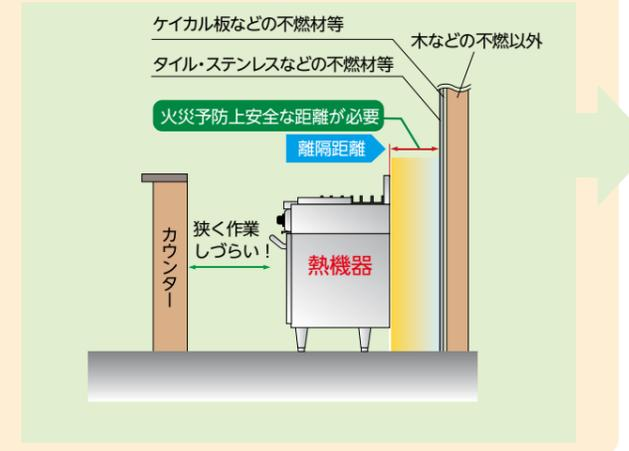
専用防熱板を機器に取り付けることによって、不燃以外
