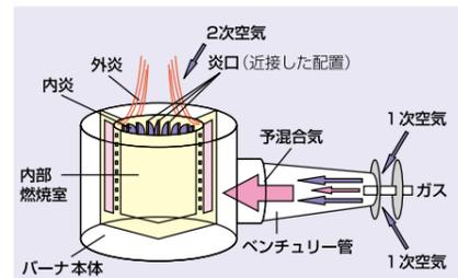
バーナ内部にスリット状の炎口を近接して配置し、さらにバーナ中央下部からの2次空気の流入を塞いだ内部燃焼室内を持つ。
