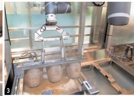
1 2本のロボットアームが稼動する厨房。左から順に「ゆでる」「洗う」「締める」の手順で調理が進む。
